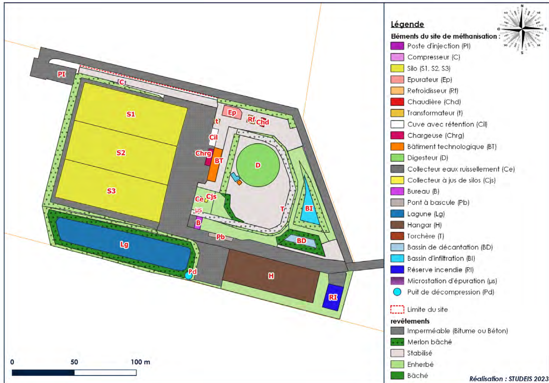
Figure 2. Agencement prévisionnel de l’unité de méthanisation de la SAS R&D BIO ENERGY
